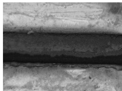
Fig. 8 第2世代「SN100C P602 D4」のくし形基板の金属顕微鏡像 (×200)
